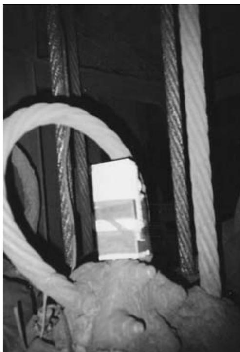
Рис.1 – Экспериментальный датчик с использованием электромагнитных волн, смонтированный на скипе ш. «ЗАРЯ» ПО Кривбасруда
