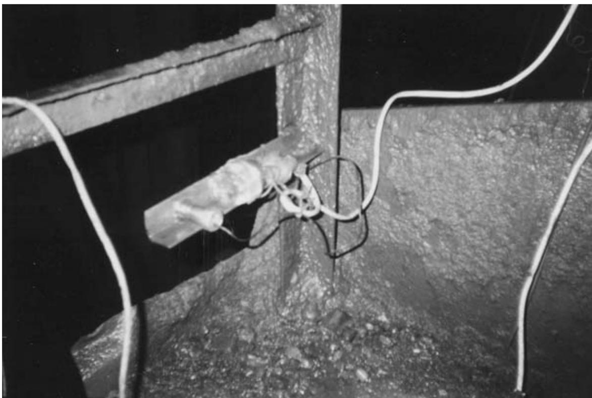
Рис.2 – Инфракрасный датчик подсчета ярусов, смонтированный на скипе ш. им. Фрунзе ОАО «Сухая Балка»
